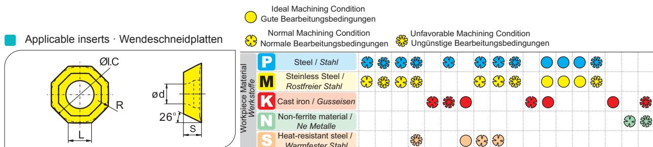
Chipbreaker Selection FMA04 · Spanbrecher Auswahl FMA04
