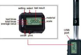
PORTABLE LEEB HARDNESS TESTER
