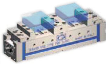
1 ganasce fissa centrale Art.805F + 2 ganasce mobili lisce Art.8100 con gradino piccolo (3x5) e grande 1 fixed central jaw Art.805F + 2 smooth movable jaws Art.8100 with small (3x5) and big step
