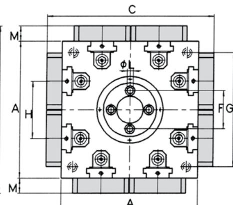
Ogni cubo è completo di 8 ganasce fisse (Art.845) e 16 ganasce mobili (Art. 810), 1 chiave a pipa, tasselli di posizionamento e 16 arresti laterali.
