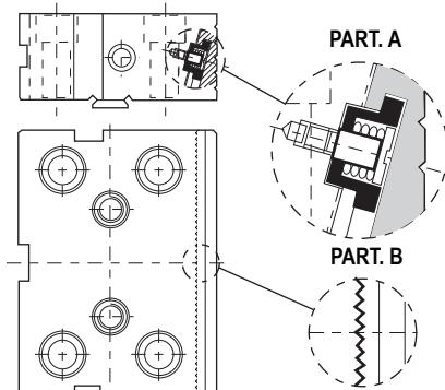
**RAPIDA SOSTITUZIONE DELLE PIASTRE GANASCE DISCENDENTI SENZA BISOGNO DI ALCUN UTENSILE**
